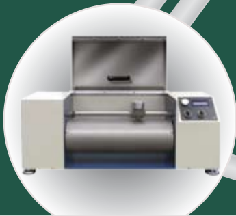
Testgerät für Abrasionsresistenz - DIN Zur Prüfung der Abnutzungsresistenz von Elastomeren.
